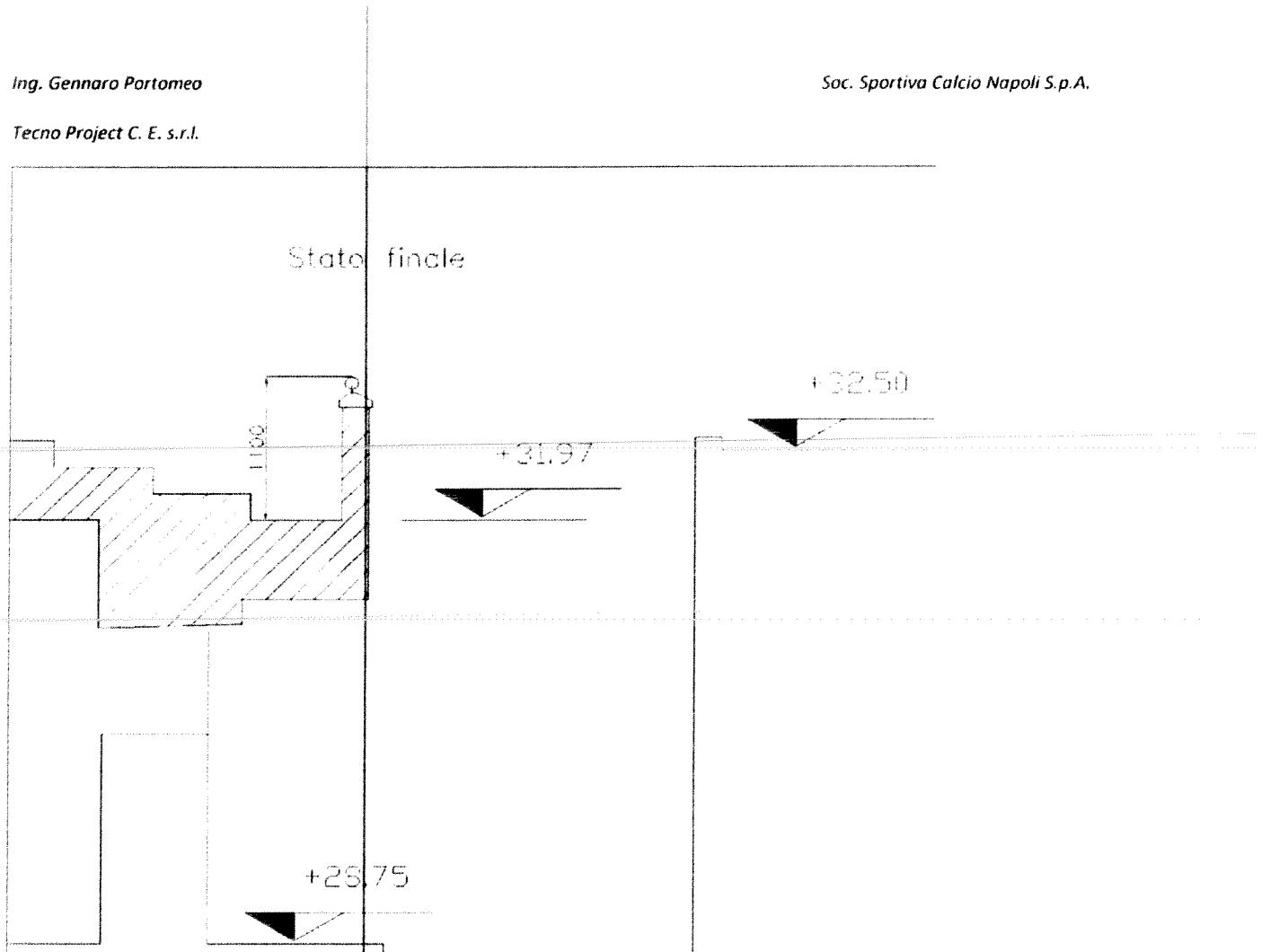
misure del parapetto in mm
